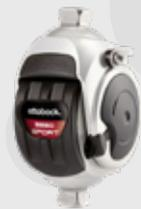
3S80 Articulación de rodilla deportiva compacta y robusta, preparada para soportar grandes cargas que aparecen y actúan sobre la prótesis al correr. Sistema hidráulico rotativo robusto con opción de bloqueo manual. Sistema de oscilamiento libremente hasta un ángulo de flexión de 60°. Con amortiguación de flexión y extensión de ajuste individual.
